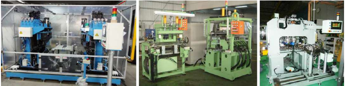
ラジエーター・コンデンサー自動組付け機
